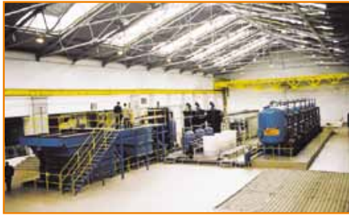
Wasseraufbereitung für Kohlebergwerk 3.000 m 3 /Tag Kattowice, Polen
