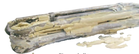
Eine verkalkte Heizspirale verschwendet Energie
