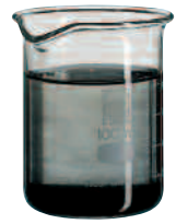
Schlamm aus einer alten Heizungsanlage.
