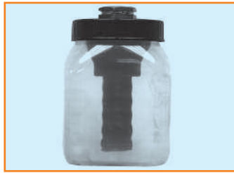
Après introduction de l'aimant, l'ensemble de la boue est rapidement retenu pour être évacué.
